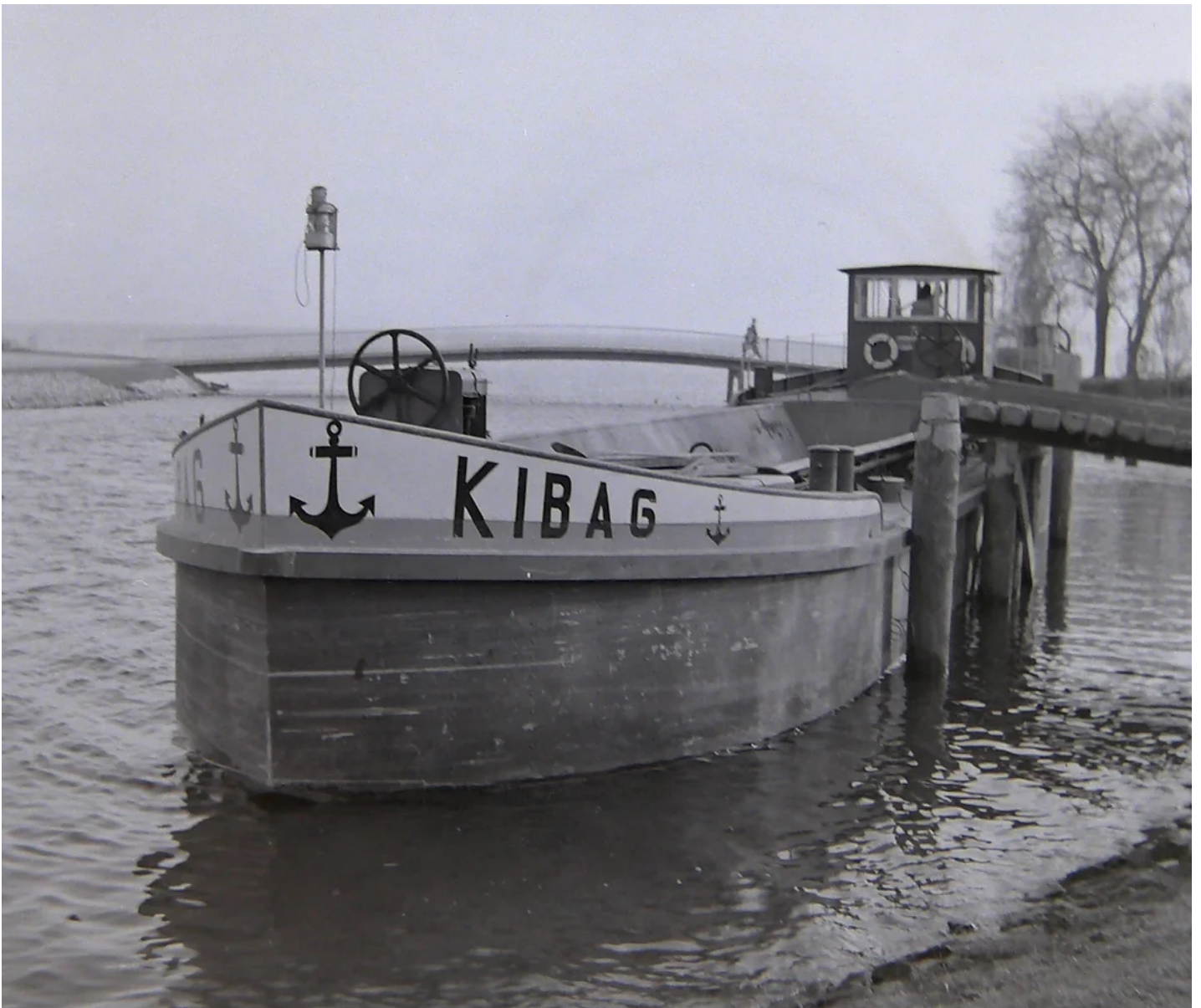
Spezialschiff der KIBAG mit dem aufklappbaren Boden des Laderaumes. Foto Peter Härtli. Privatbesitz.
