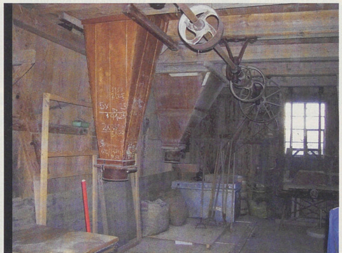
Der elektrische Antriebsmotor der ganzen Mühle (hinten links) mit an die Decke montierter Transmission. (Kraftübertragung in die oberen Stockwerke)
