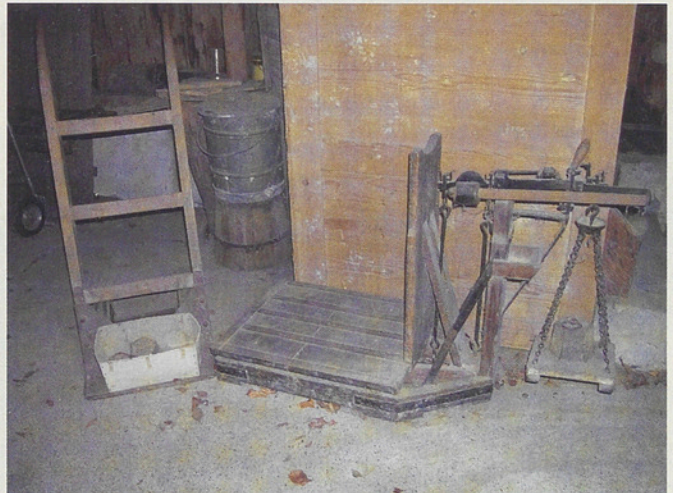
Mit dem Sackkarren links der Waage wurden die Getreide- und Mehlsäcke herumgekartt. Rechts die Dezimalwaage.
