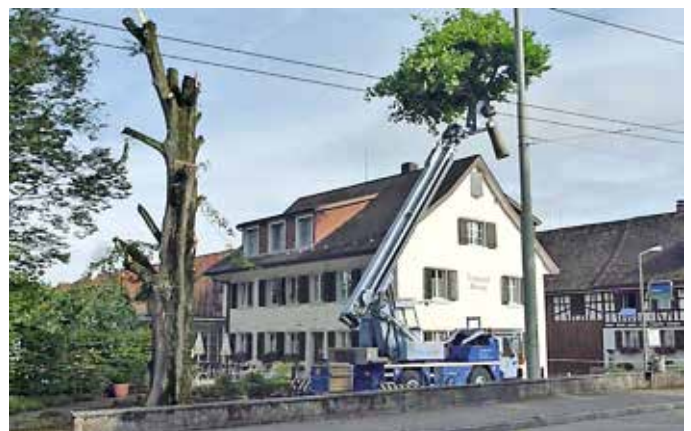
Mit dem Fällmobil wird die Krone, sowie Ast um Ast vom Baum getrennt dann sachte und sicher am Boden deponiert.
