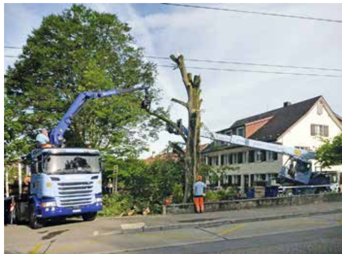
Mit Hi-Tech-Geräten (dem Fällmobil und dem Kranlastwagen) ist die frühere Tagesarbeit heute in Stunden rasch und sicher erledigt.
