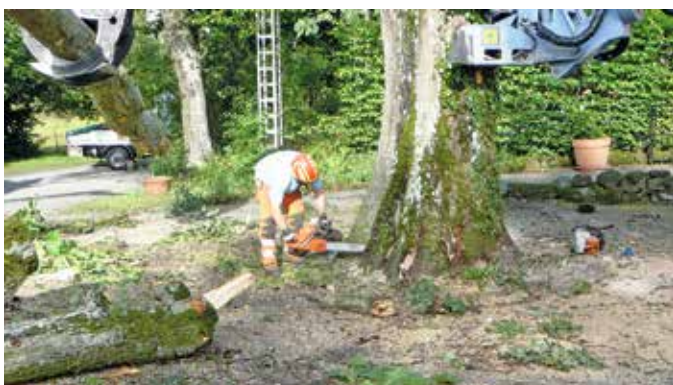
Der Fällkopf fixiert den Baumstamm sicher, so dass der horizontale Grundschnitt gesägt werden kann. Der Baumstamm ist nun bereit zum Abtransport.
