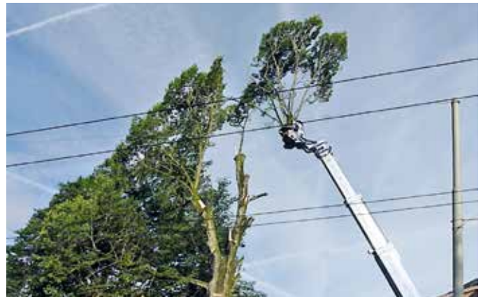
Mit dem Fällmobil wird die Krone, sowie Ast um Ast vom Baum getrennt dann sachte und sicher am Boden deponiert.
