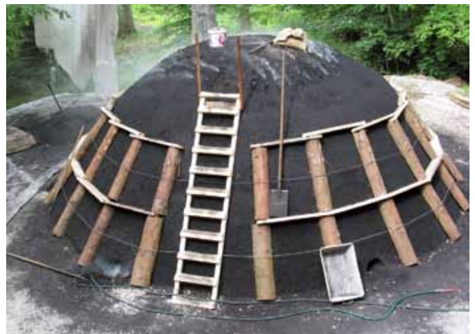
Über den Reisigmantel wird eine Schicht aus Löschi (Feines Holzkohlengries der letzten Jahre) abgedeckt und ein Stützkorsett aus Hölzern angelegt.
