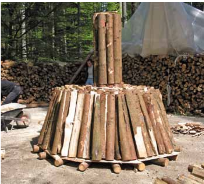
Der Grundstock mit dem Füllihaus («Kamin») und den untersten Schichten Holz ist bereit.
