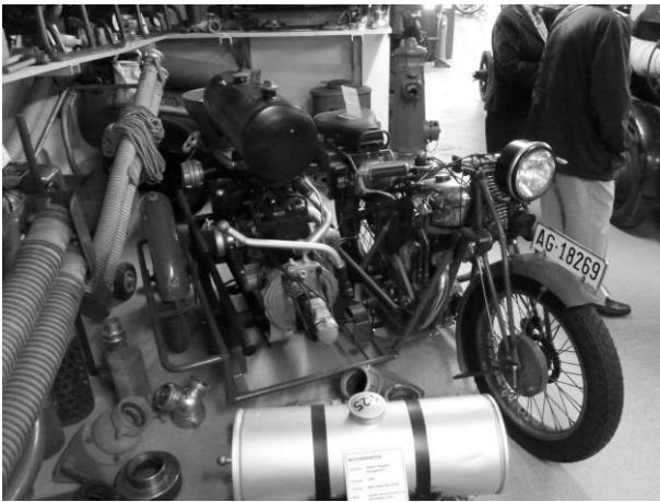
Das Motorrad aus dem Jahre 1927 mit der Motorspritze im Seitenwagen
