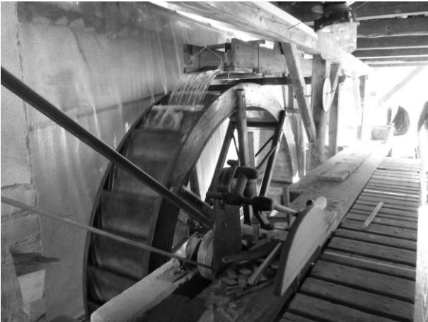
Das grosse Wasserrad der Sägerei.
