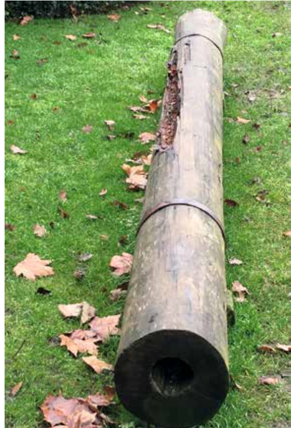
Teuchel hiessen die ersten Wasserleitungen in Winterthur. Die durchbohrten Baumstämme transportieren das Wasser von den Quellen in die Badstuben und öffentlichen Brunnen.
